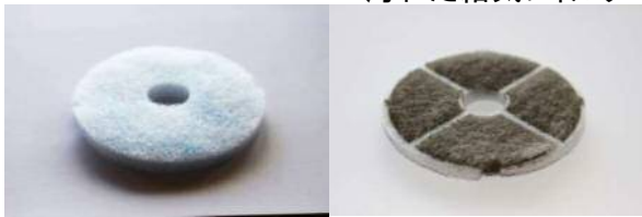
汚れた給気フィルター
