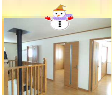
2Fのどこへ行っても、明るい陽射しが差し込み、吹抜けの煙突から、薪ストーブの暖かさが部屋中に広がっています。これは、高断熱高気密住宅だからこそ! A様邸のC値(相当隙間面積)は0.6cm 2 /m 2 と、数字でもいい結果が性能の良さを示しております。
